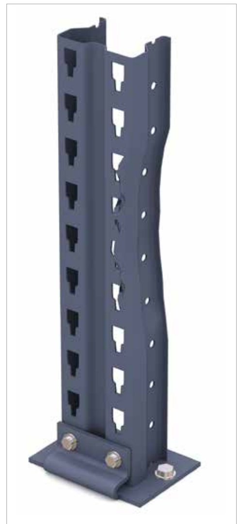
Stâlp de susținere îndoit
