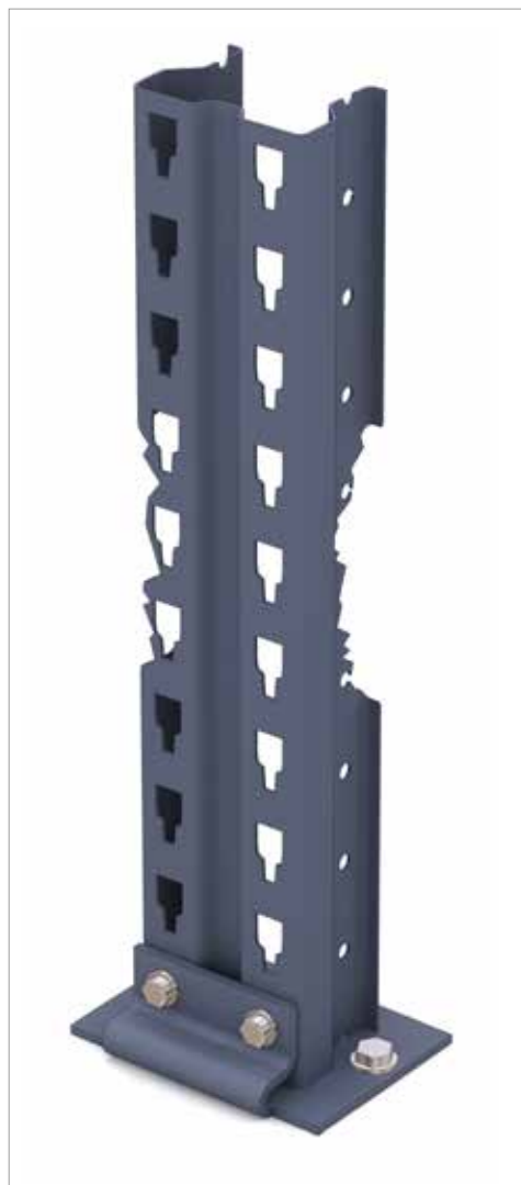
Stâlp de susținere crăpat
